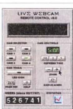
Molte delle WebCam poste nei luoghi pubblici sono dotate di comando remoto per permettere ai visitatori del sito, una alla volta, di selezionare una telecamera (in questo caso ce ne sono quattro), decidere il fattore di zoom e il tempo di refresh.
